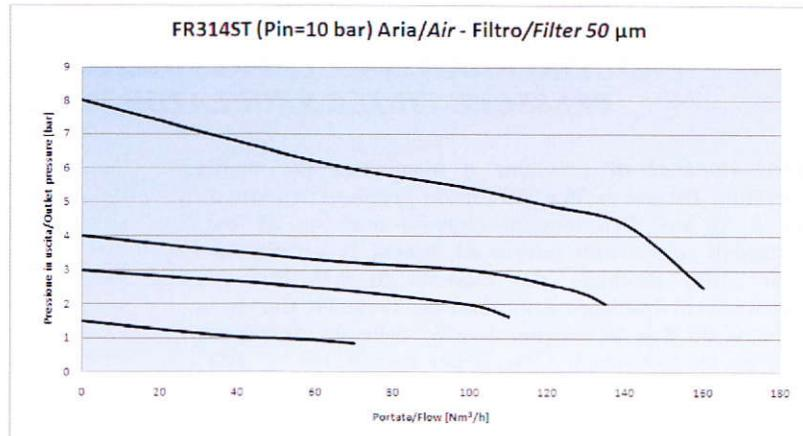
Prove di portata eseguite seguendo le indicazioni della raccomandazione UNI ISO 6358 con misuratore a diaframma UNI EN ISO 5167-2
